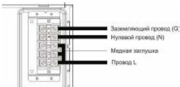
Рис 11. Однофазное подключение прибора
